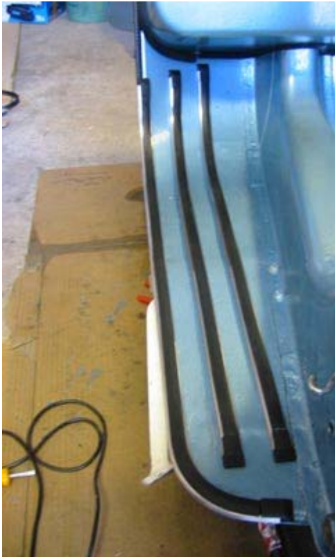
.. mit fertigen Trittleisten links...
